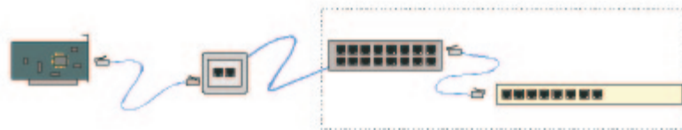
Hlavné časti štruktúrovanej kabeláže zľava: koncové zariadenie (počítač so sieťovou kartou, telefón...), pripojovací kábel, zásuvka, horizontálna kabeláž, prepojavací kábel, aktívne zariadenie (HUB, switch, telefónna ústredňa...)
