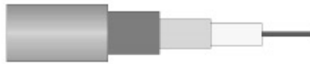
Obr. 1 Štruktúra koaxiálneho kábla (zľava: vonkajší obal z PVC, kovový oplet, hliníková fólia, izolačná vrstva plastu/dielektrikum, medený vodič)
