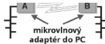
Obr. 7 Prepojenie dvoch bodov (sietí) použitím adaptérov inštalovaných priamo v počítači
