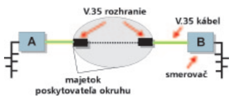
Obr. 5 Schéma zapojenia digitálneho okruhu. Namiesto rozhrania V.35 možno použiť napr. rozhranie X.21
