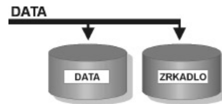
Obr. 1 RAID 1 = Mirroring/duplexing je často používaná lacnejšia alternatíva k diskovým poliám
