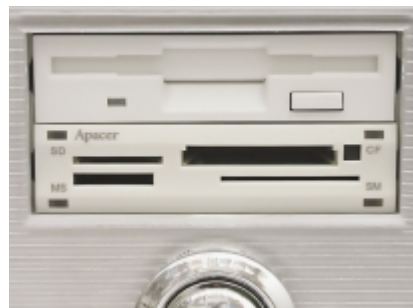
Čítačka „klasických“ pamätových kariet vo vyhotovení na zabudovanie do 3,5-palcovej mechaniky
