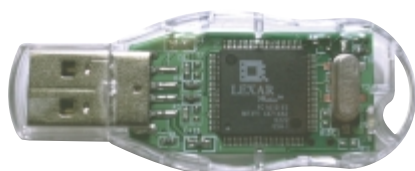
Pohľad na vnútorné vyhotovenie pamätového kľúča – v podstate ide o jeden integrovaný obvod a adaptér na pripojenie k portu USB
