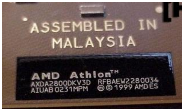
Najrýchlejší Athlon XP ThoroughBred 2800+ 333.3 MHz FSB (2.2500 GHz), na obrázku je dobre viditeľný popis, kód a séria procesora. Modely nad 2800+ majú jadro Barton.
