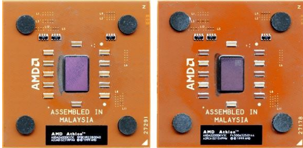
Porovnanie AMD Athlonov XP : prvý ThoroughBred 2200+ rev. OA, 266 FSB vľavo a novší ThoroughBred 2600+ rev. OB, 266 FSB vpravo (rozdiel nie je voľným okom poznateľný)
